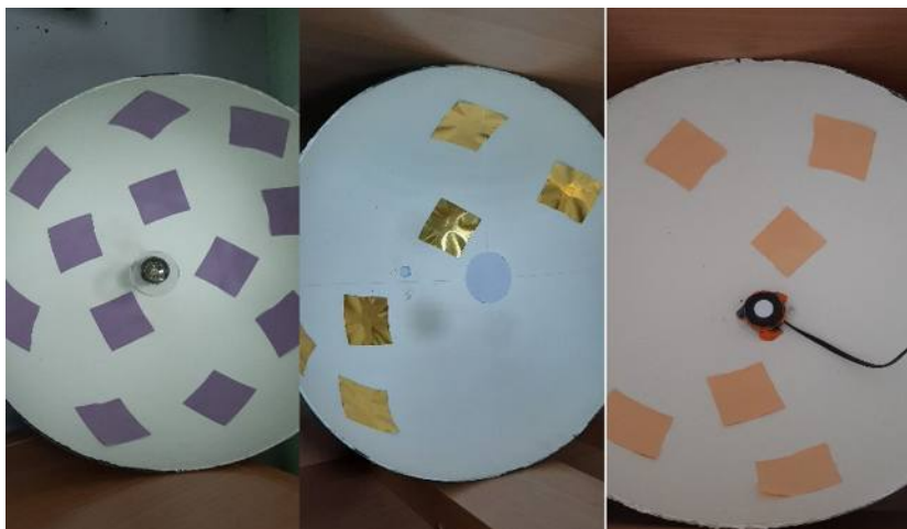
Рис. 3. Образцы в прототипе установки блескомера
